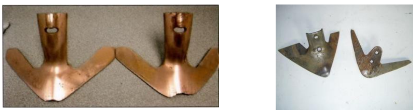
Рис. 1.3. Износ носовой части стрелчатых лап
