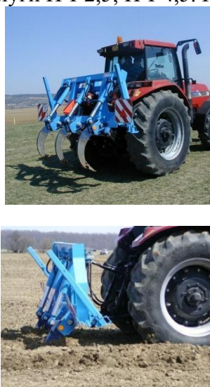
Рис. 2.20. Чизель-глубококорыхлитель фирмы Farmet
